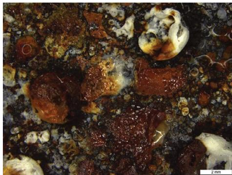
**Рис. 5.** Фотофиксация испытаний покрытия на основе углеродных нанолуковиц, декорированных детонационными наноалмазами, на биостойкость с двумя штаммами биодеструкторов в тест-системе с добавлением среды Чапека на 10.08.23: *а* и *б* – панорамные фото, *в* и *г* – с использованием стереомикроскопа Leica. Балл развития для *Aspergillus niger* и *Penicillium chrysogenum* – 0.
